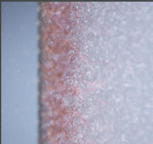
Bei jedem Waschgang werden zahlreiche Mikroplastikfasern aus synthetischer Kleidung freigesetzt. Der Filter entfernt beim Waschen zuverlässig Mikroplastikfasern größer als 0,045 mm.
